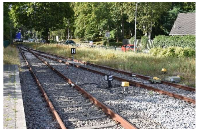
Gleissperre am Umfahrgleis (Simulation Gl. 3)
